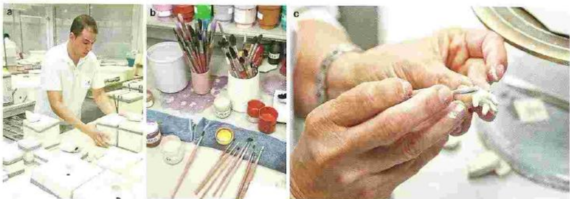
a. 練込み型は、その寿命対策のためマスターモデルが作られ保管。b. 約4,000種にも及ぶ独特の色調は、全て天然の色素を調合して構成。一筆のミスが致命傷となるため、絵付け師は安定した手の動きと集中力、豊富な経験が必須。c. 小さなシェーパーを巧みに操りながら成形。デザインを忠実に再現するための重要な仕事。
